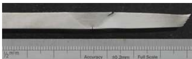
Figura 7. Una sección metalográfica a través de un FSW intencionalmente defectuoso en acero DH36 de 6 mm. de espesor. La zona del fallo está en el metal principal al lado derecho de la muestra.
